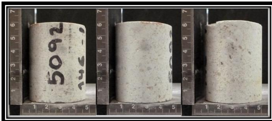
Figura 3.2 Registro fotográfico cada 120 grados de una probeta de roca para ensayo PLT.
